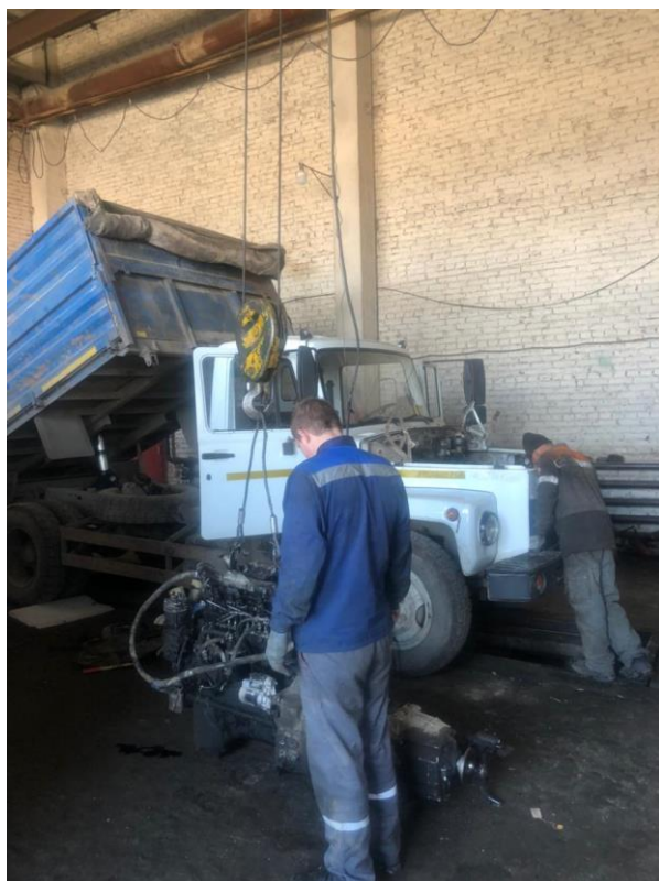
Рис. 21. Отряд «Агроинженер». Ремонт двигателя автомобиля ГАЗ-3307 в мастерской УНПО «Муммовское».
